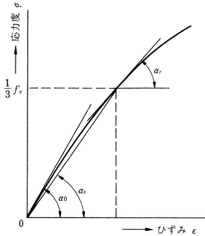
図-1.17 コンクリートの応力とひずみの関係と弾性係数の定義
