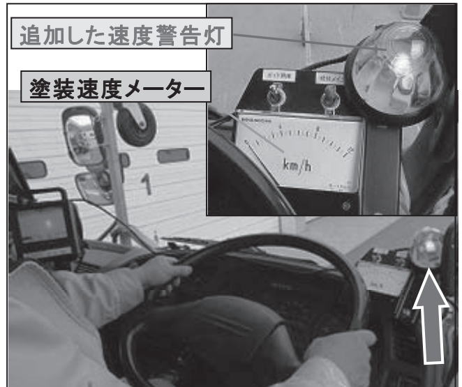
図-10 運転席に設置された速度警告灯
