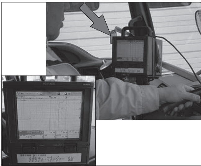
図6 ペイントマーカ車に設置されたクオリティマネージャーQM
