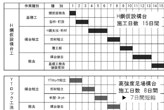
図-4 作業構台 作業工程日数比較
