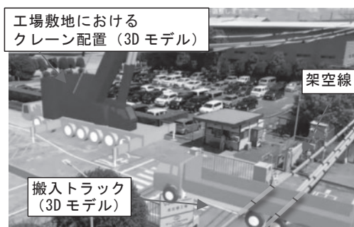
図-5 落とし込み架設時のMR再現状況
