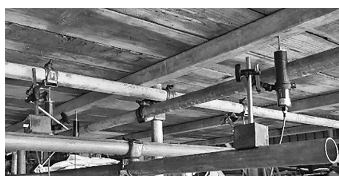
図-9 変位計によるたわみの計測
