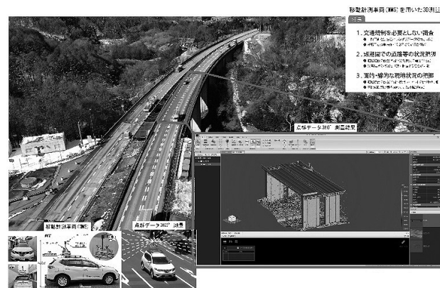
図-8 3Dスキャナによる測定～反映 概要図
