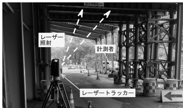
図-2 レーザートラッカーによる調査状況
