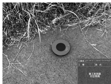
図-4 精度検証点（製品名：エアロボマーカー）
