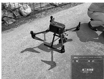
図-2 UAV（製品名：DJI Matrice 300 RTK）
