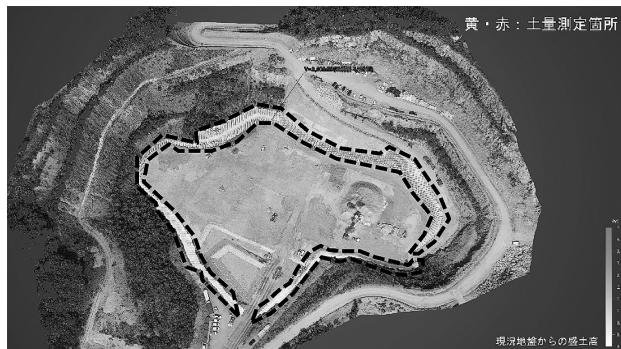
図-3 三次元測量による土量測定結果（吸着層部）
