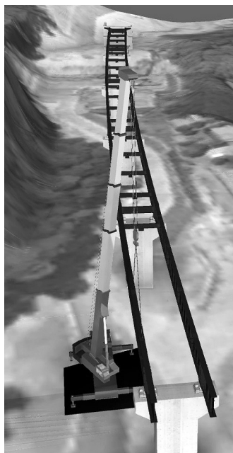
図-2 3D架設計画シミュレーション
