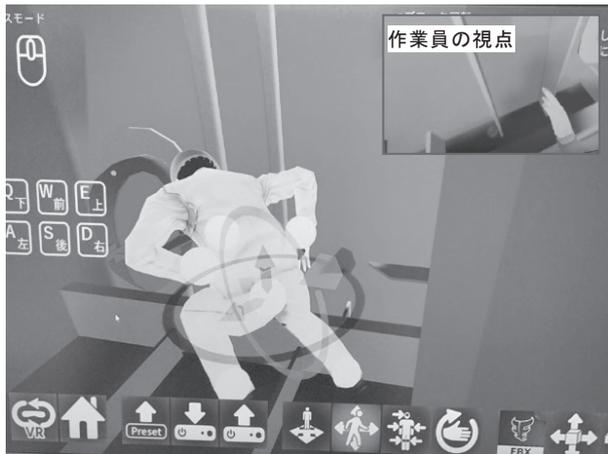
図-5 VRを用いた支点近傍での作業姿勢の確認
