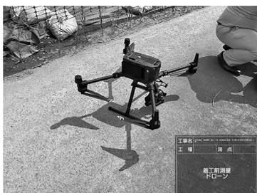
**図-2 UAV (製品名：DJI Matrice 300 RTK)**
