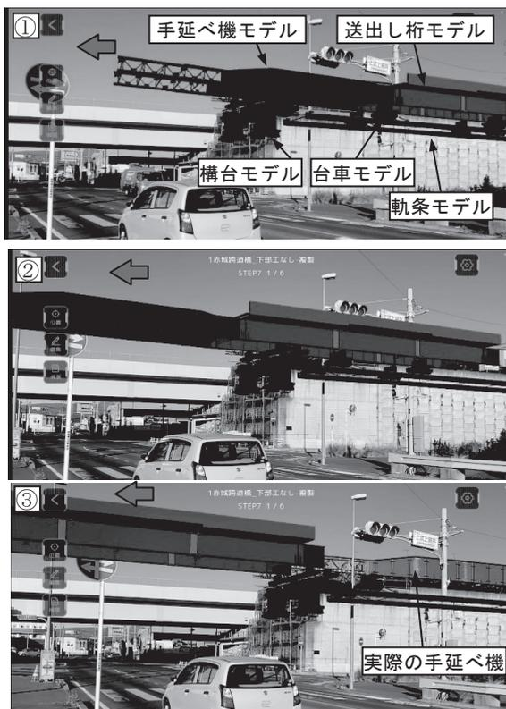
図-1 送し施工モデルのAR重畳（交差点上）
