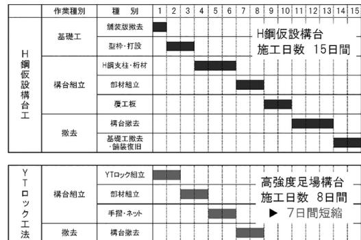
図-4 作業構台 作業工程日数比較
