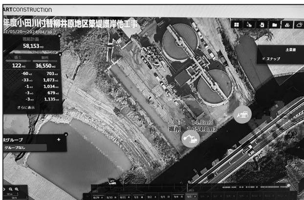
図-1 クラウド上での施工量計測状況
