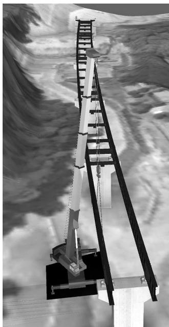
図-2 3D架設計画シミュレーション
