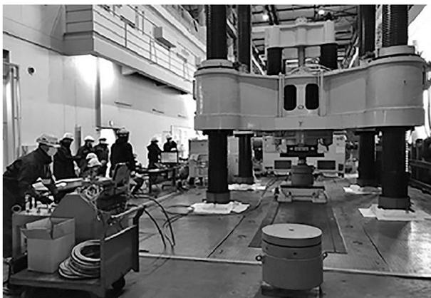
図-7 油圧ジャッキ校正状況
