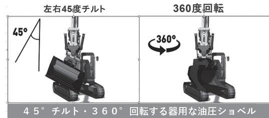
図-6 チルトローテータバックホウ
