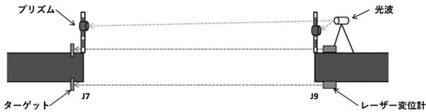
図-9 レーザー変位計設置状況
