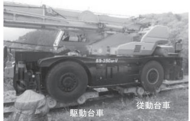
図-4 ラフテレーンクレーン運搬台車
