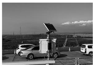
図-2 車両感知装置
