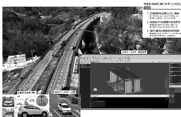
図-8 3Dスキャナによる測定～反映 概要図
