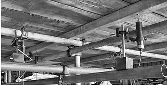
図-9 変位計によるたわみの計測
