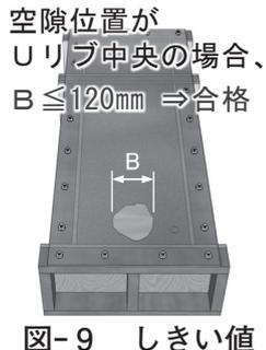
210mm区間では、3%勾配配置と水平配置で両方も空隙幅Bが15mm以下であり、良好な結果が得られた。一方700mm区間においては、3%勾配配置では空隙幅Bの平均値がしきい値(図-9)に対して10%未満(9.6mm)、最大値が同25%(30mm)であったため、良好なモルタル充填が可能と判断できた。他方水平配置では、空隙幅Bの平均値が83mm、最大値が100mmとなり、しきい値内ではあるが空隙幅の最大値が3%勾配配置に対して約3.5倍大きくなること判った(-表-)。実験結果より、本施工での充填口及び空気孔の配置は実験器具と同様に、密閉ダイアフラム面から50mm以内にそれぞれの孔の中心を配置することとした(図-10)。
