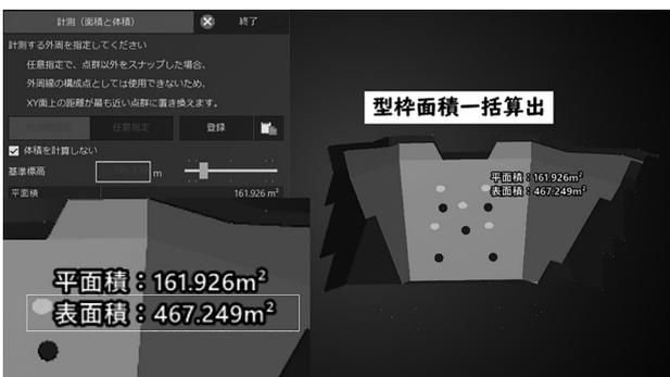
図-12 型枠面積一括算出
