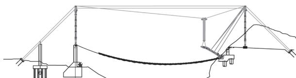
STEP-2：P3側アーチ基部～張出部まで架設
