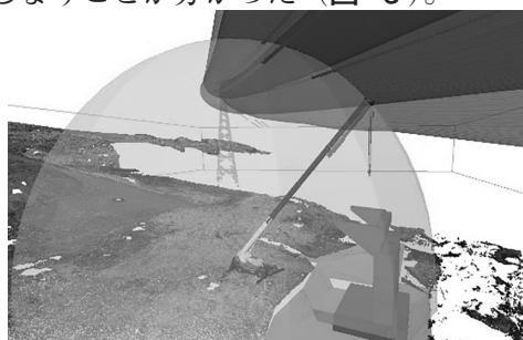
図-3 25tラフテレーンクレーン最大作業範囲（水色半球）と送電線安全距離（赤円筒）の関係
