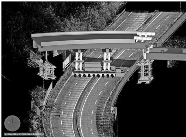
図-5 3Dモデルを用いたシミュレーション
