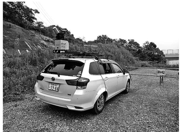
図-3 MMS計測車両
