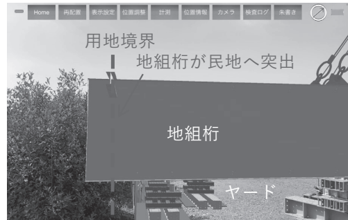
図-4 架設状況の検証
