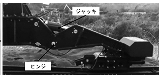
図-5 脚部ジャッキ伸縮動作
