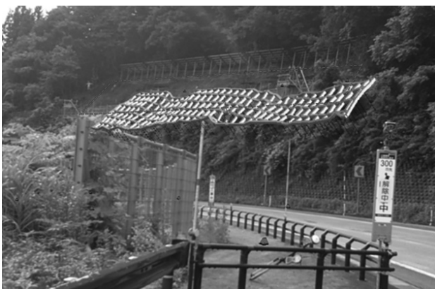
図-10 GNSS捕捉数が少ない時のモデルのずれ
