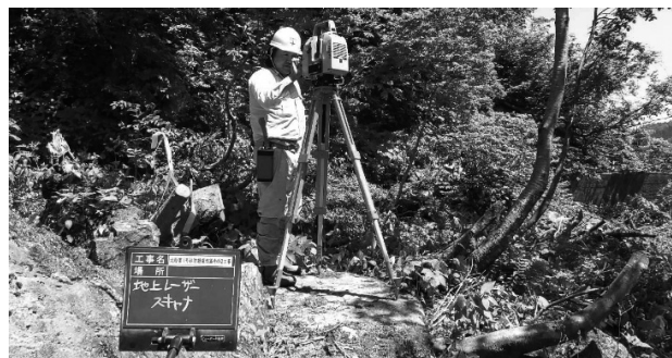
図-3 TLS点群測量状況
