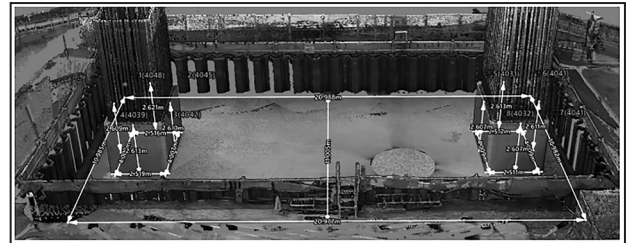
図-9 解析後データ(点群による出来形計測)
