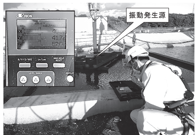
図-4 堤防振動測定状況の写真
