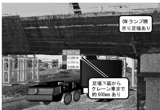
図-3 障害物との接触確認
