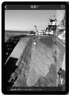
図-3 ガット船測りマス写真測量計測
