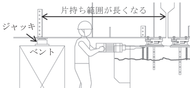
図-4 ベントによるジャッキアップ案
