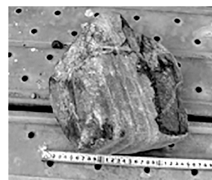
図-5 一部分破碎し排土された礫
