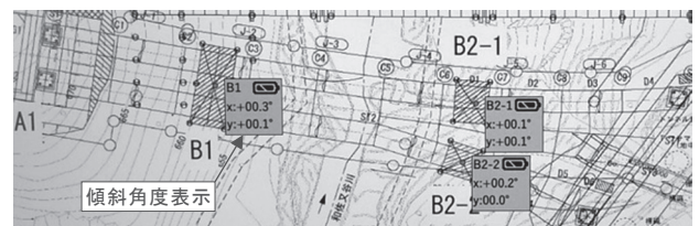
図-5 傾斜監視システム
