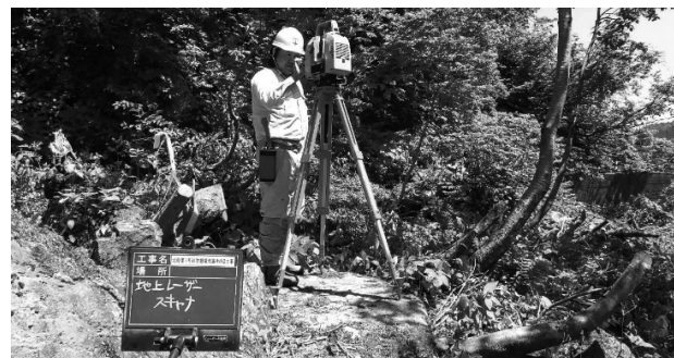
図-3 TLS点群測量状況
