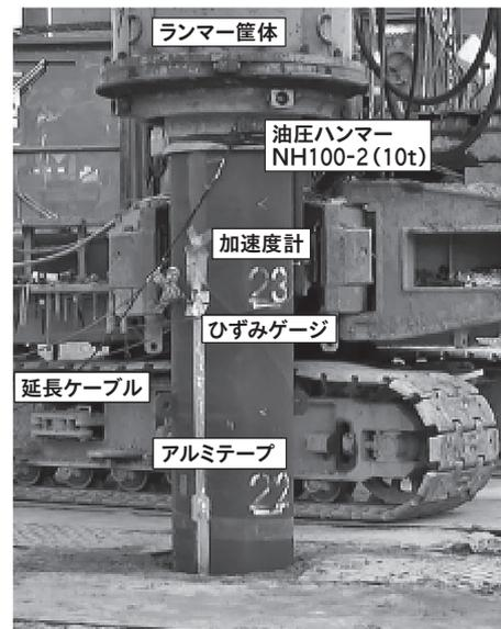
図-3 加速度計，歪みゲージ設置状況
