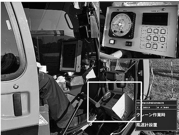
図-3 クレーン運転席 風速計器
