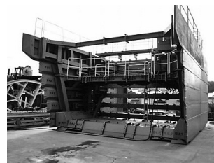
図-1 シールド機仮組立状況
