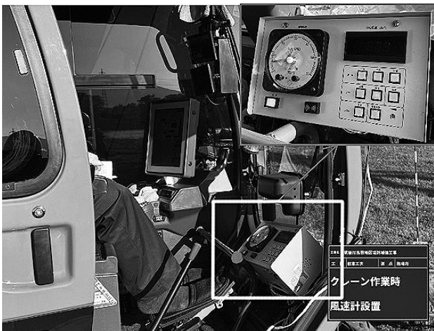
図-3 クレーン運転席 風速計器
