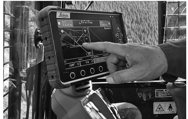
図-6 三次元モニターによる掘削箇所確認
