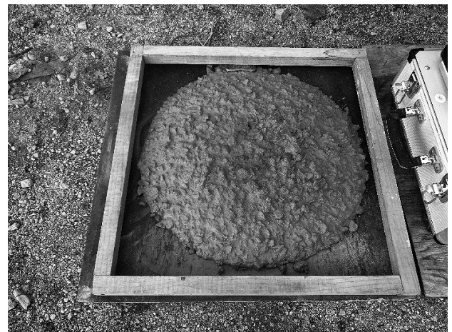
図-7 T-ポストスランプ試験
