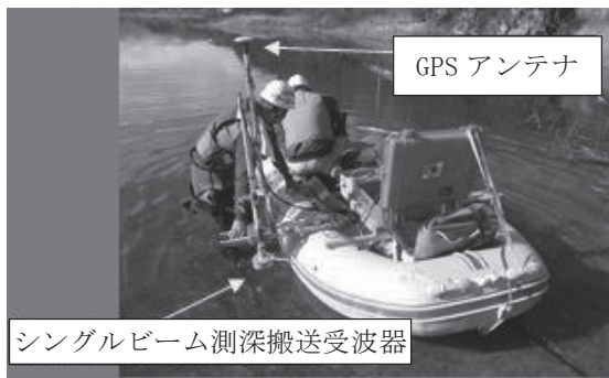
図-2 シングルビーム深浅測量状況
