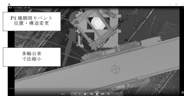
図-4 P3-P4架設計画変更後
