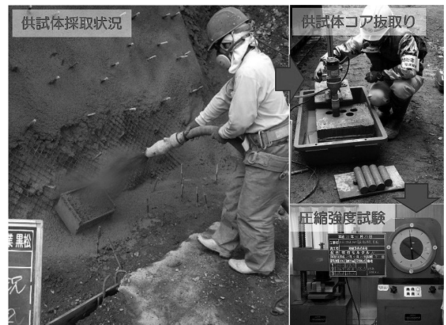
図-9 供試体採取及び強度試験
