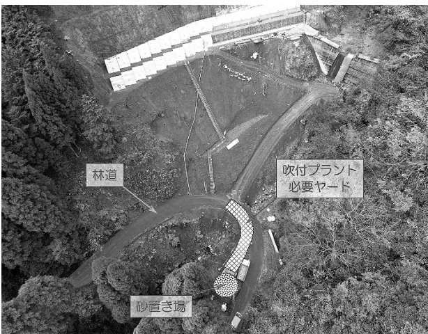
図-3 従来吹付プラント設置計画
