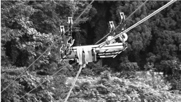
図-11 吊下げ式UAV写真測量
