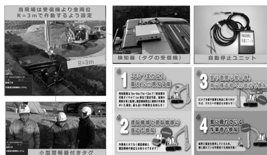
図-4 作業者接近システム+自動停止ユニット
