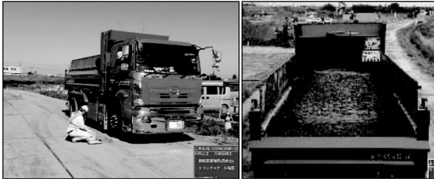
図-6 トラックスケールと積載高さ明示
