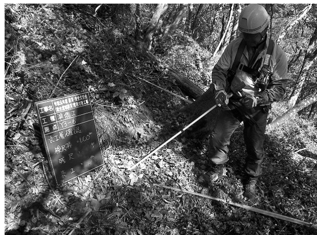
図-3 ロープスティックによる表層厚確認
