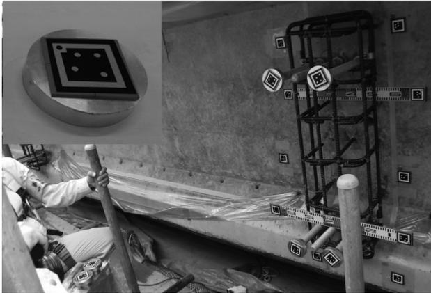
図-4 デジタルカメラ計測用ターゲット及び計測状況 (Aライン)
