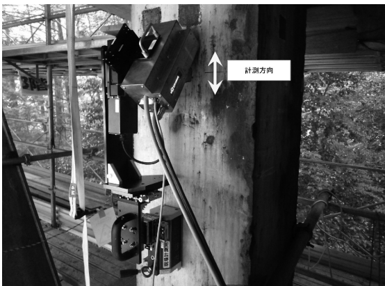
図-2 X線残留応力計測状況
