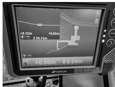
図-3 ランプ部におけるバックホウのモニター
