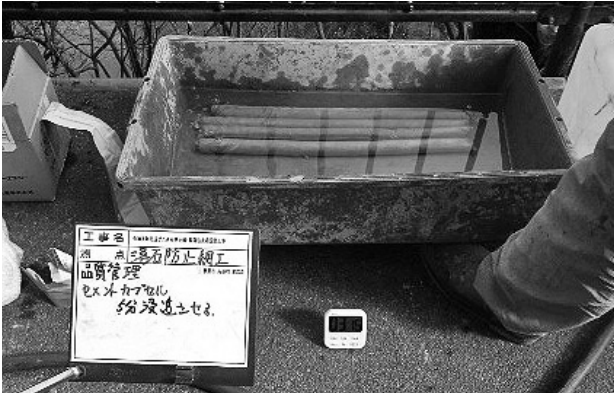
図-2 カプセル浸漬状況(キッチンタイマー使用)
