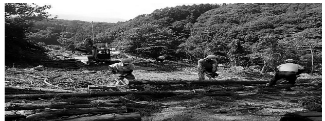
図-5 伐倒した立木を索道で運搬 平坦な荷取場で玉切り
