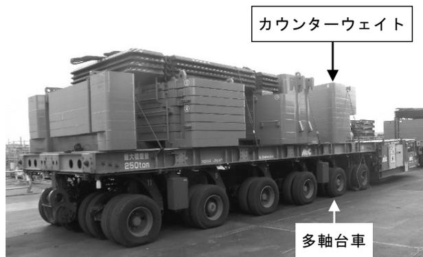
図-2 ウェイト運搬用多軸台車
