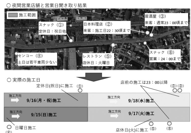
図-1 店舗への聞き取りと施工日
