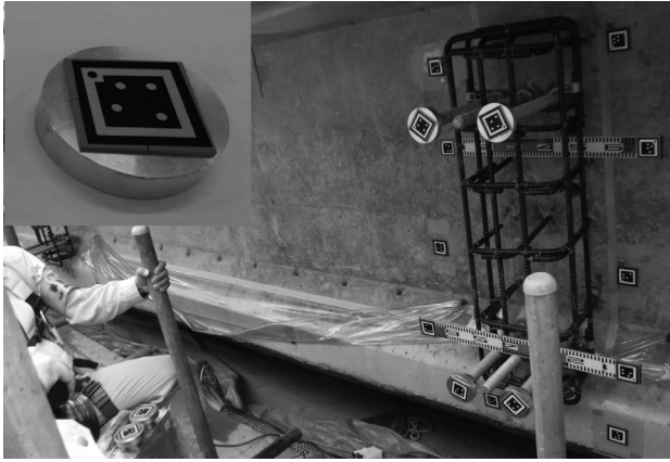
図-4 デジタルカメラ計測用ターゲット及び計測状況 (Aライン)
