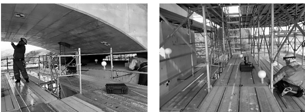
図-4 3Dスキャナー計測状況
