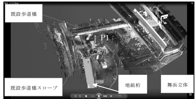
図-5 架設シミュレーション 地切り
