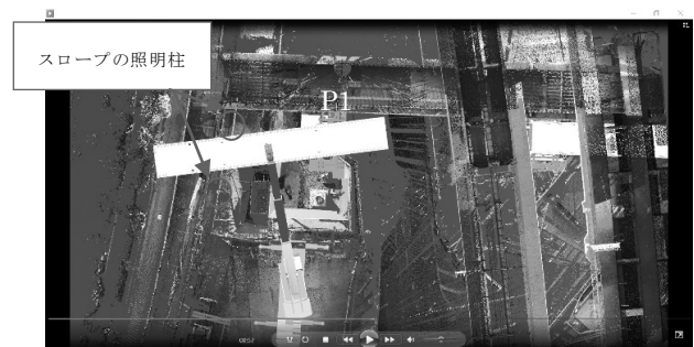
図-7 既設歩道橋照明柱間への桁落とし込み
