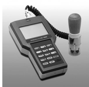
図-2 コンクリート・モルタル水分計
