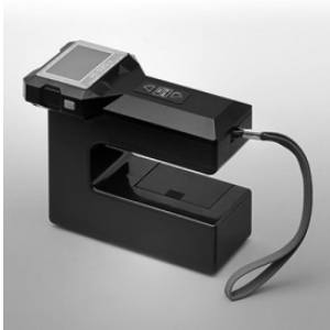
図-2 コンクリート・モルタル水分計
