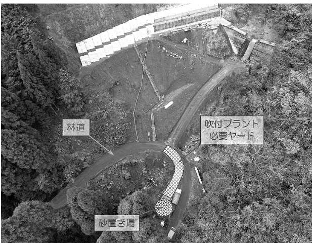
図-3 従来吹付プラント設置計画
