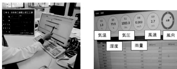
図-3 常時風速監視システム確認画面
