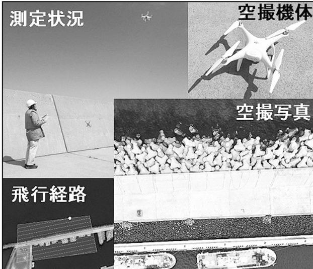
図-3 UAV測量実施状況
