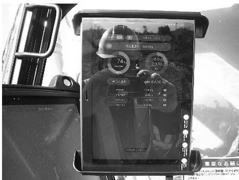
図-12 過積載防止対策 実際の使用状況
