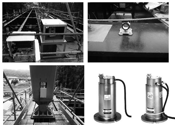
図-3 3次元自動計測器（上）と傾斜計（下）
