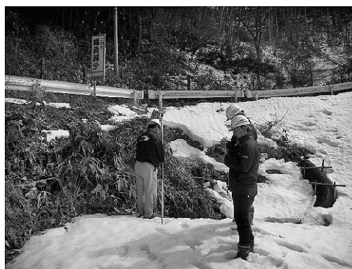
図-9 GNSS受信状況確認
