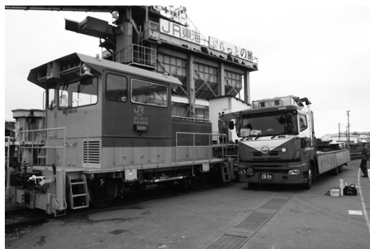
図-8 新幹線保守用車 積み込み状況
