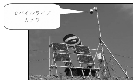
図-5 ソーラーパネル式モバイルライブカメラ
