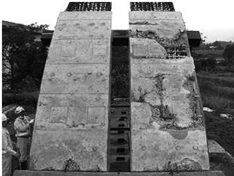
図-4 試験施工結果（スランプ左15cm、右8cm）
