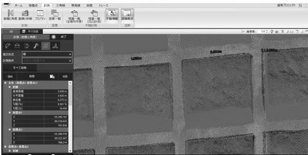
図-10 法面工 吹付枠梁長計測
