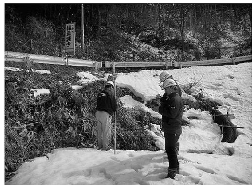
図-9 GNSS受信状況確認
