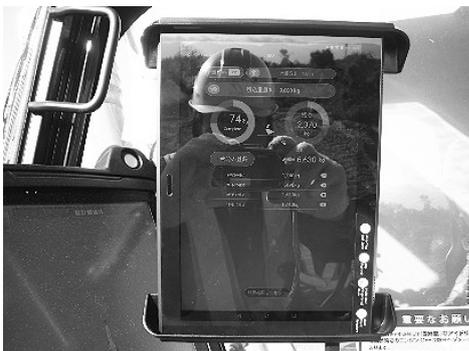
図-12 過積載防止対策 実際の使用状況
