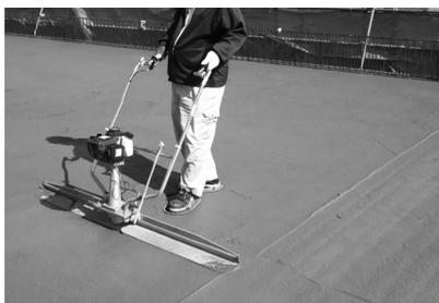
図-4 振動機付締固め機（実機）
