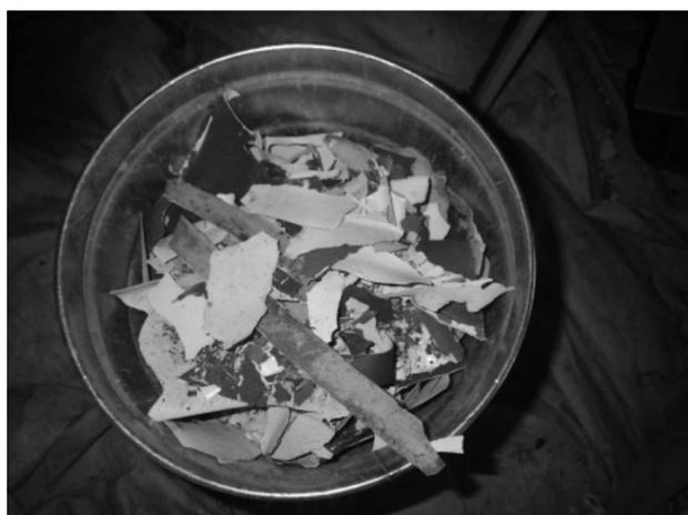
図-11 「IH」工法で除去した塗膜の回収
