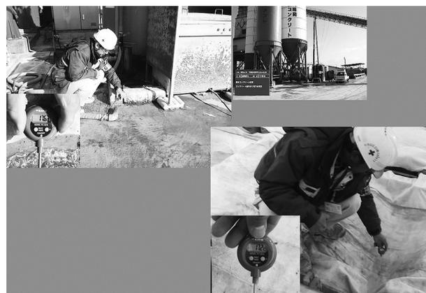
図-4 養生水温度測定
