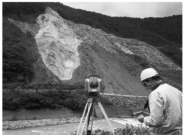
図-4 地上レーザースキャナ測量
