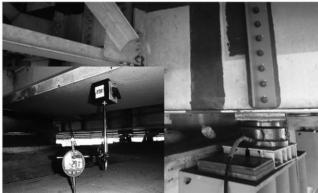
図-8 ジャッキアップ状況とダイヤルゲージ
