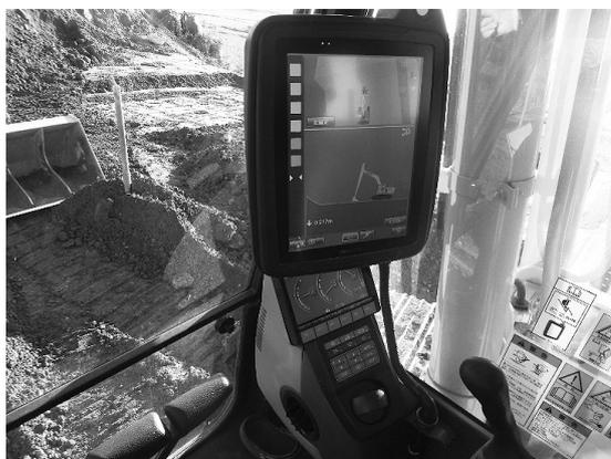
図-3 3Dマシンガイダンスバックホウ
